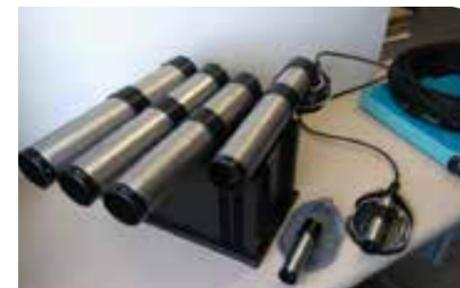
Mesurer le sens et la vitesse du vent loin devant le bateau, c'est permettre d'optimiser les réglages avec un temps d'avance. Sur ce principe, le projet WINDFIELD développe une solution lidar capable de mesurer le vent à grande distance en temps réel. Elle est basée sur une architecture innovante en réseau, testée en conditions extrêmes : la course au large.
